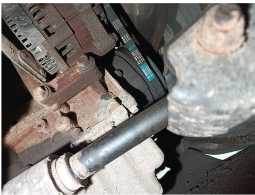
Течь соединений передней крышки ДВС (осмотр снизу)
