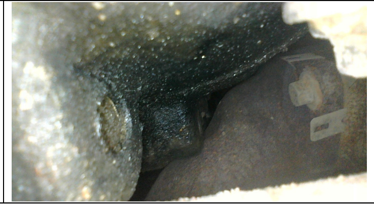
Течь соединений системы охлаждения (осмотр снизу)
