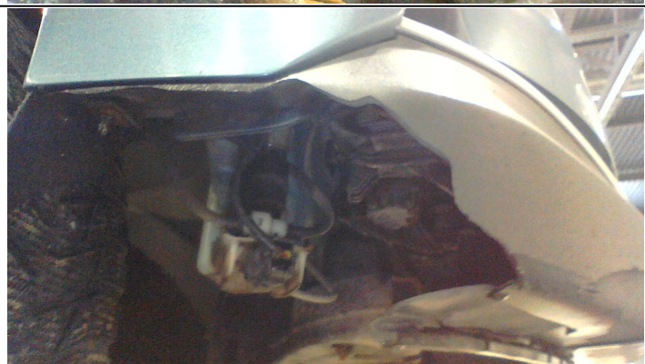
Течь соединений турбины (осмотр снизу)
