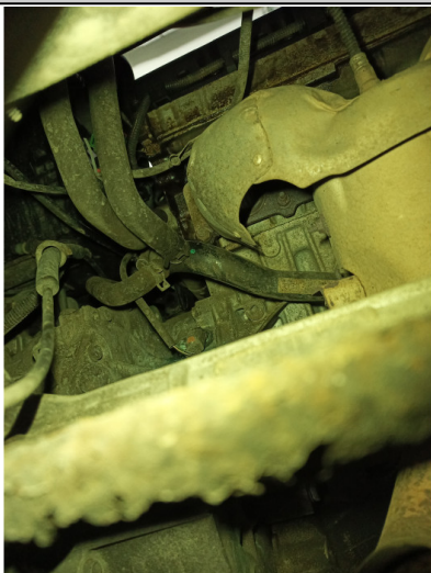
Течь соединений передней крышки ДВС (осмотр снизу)
