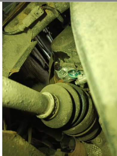
Течь соединений передней крышки ДВС (осмотр снизу)
