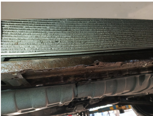
Радиаторы систем охлаждения двигателя, ГУРа, трансмиссии, радиатор кондиционера, опоры ДВС и КПП.
