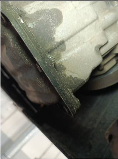
Течь соединений передней крышки ДВС (осмотр снизу)
