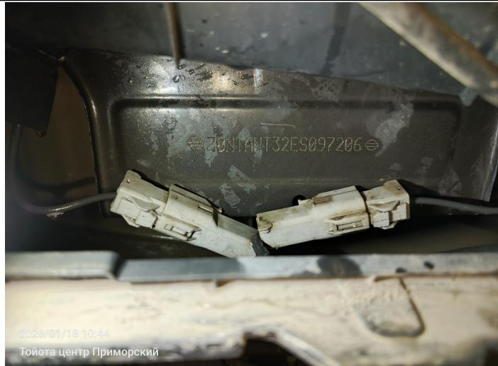
Течь соединений передней крышки ДВС (осмотр снизу)
