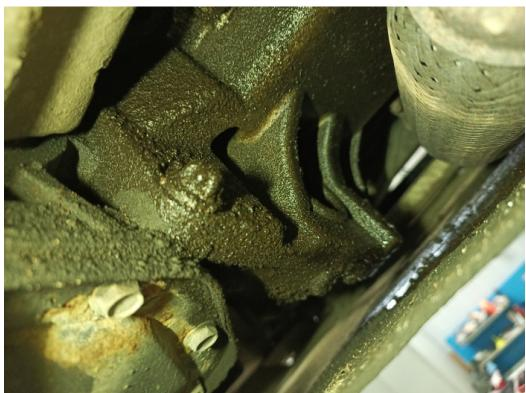
Течь соединений переднего редуктора
